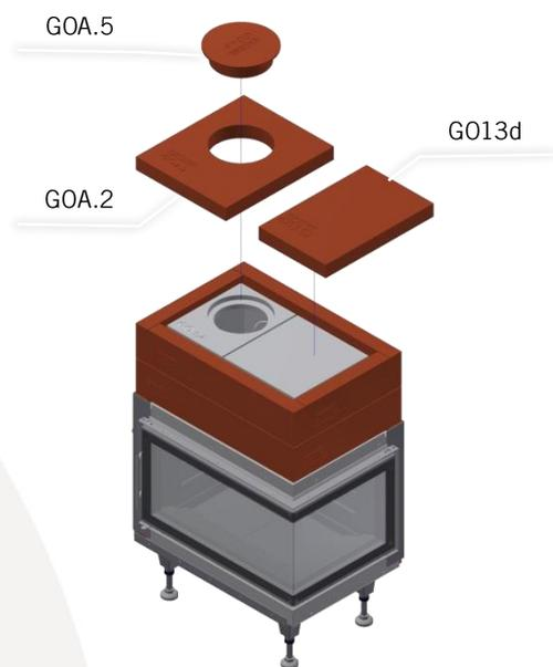
Verkleben Sie den Deckel des Mantels mit den Seitenteilen.
