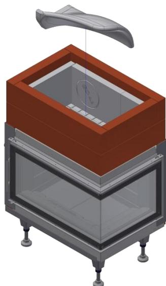
Positionieren Sie die Umlenkplatte auf den GOS, und schieben Sie diese immer ganz nach hinten und zur Seite des Ausbrandes.
