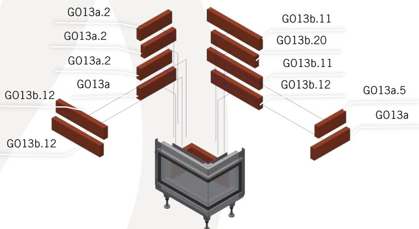
Bevor Sie mit den Mantelsteinen über die Tür mauern, ist diese mittels den seitlichen Klemmleisten winkeligerecht zur Bodenplatte auszurichten und festzuschrauben.
