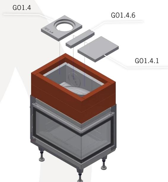
Positionieren Sie nun die Abdeckung der Nachbrennkammer.
