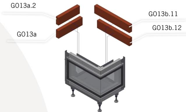
Setzen Sie zunächst die 1. Reihe der Mantelteile trocken auf die Fasermatten ins Grundgestell.
